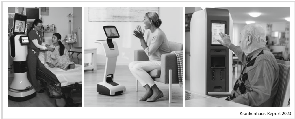
▣ Abb. 12.4 Beispiele für Roboter zur Unterstützung der Pflege: Telepräsenzroboter RP-Vita mit integriertem Stethoskop, Medisana Robot RO 100 für Telepräsenz- und Interaktionsfunktionen, robotischer ServiceAssistent für
